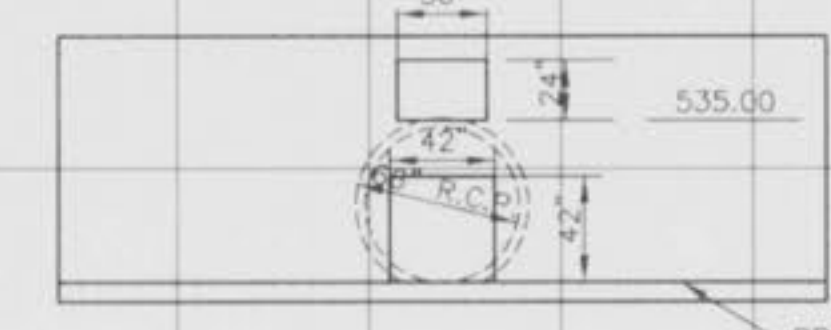
OVERFLOW STRUCTURE N.T.S.
