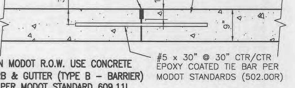
LONGITUDINAL PAVEMENT JT. (MODOT) NO SCALE
