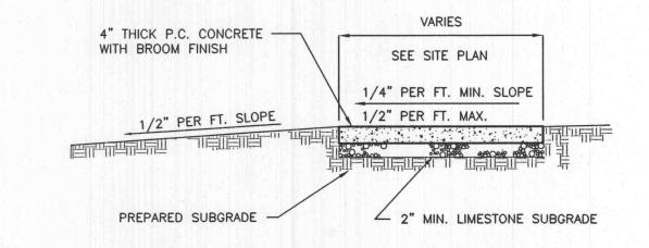
NOTE: MAXIMUM DISTANCE BETWEEN EXPANSION JOINT SHALL BE 10' WITH AT LEAST ONE CONTROL JOINT IN
