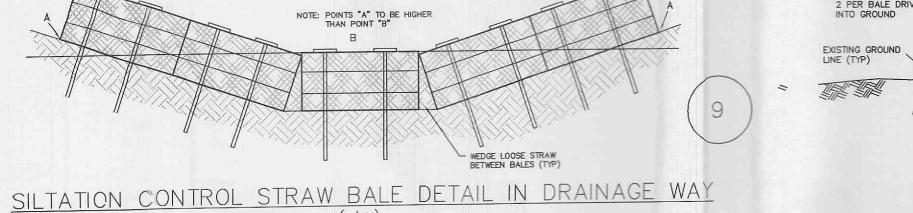
2 PER BALE DRIVE INTO GROUND 15 6 6 6 6 6 6 6 PLAN VIEW EXISTING GROUND SECTION B-B SECTION A-A SILTATION CONTROL
