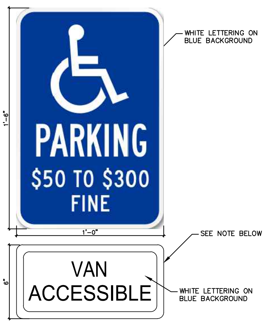
ACCESSIBLE SIGN DETAIL (n.t.s.)
