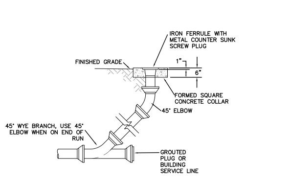
TYPICAL DETAIL AT VOLLEYBALL COURT UNDERDRAIN COLLECTOR PIPE
