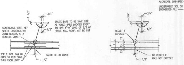
UNDISTURBED SOIL OR ENGINEERED FILL - NO REGLET IF - 1 1/2" WALL NOT EXPOSED TYPICAL WALL CONTROL JOINT
