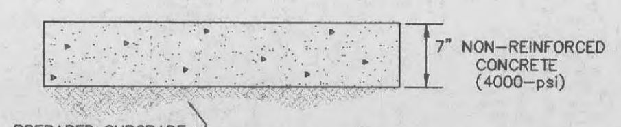
CONCRETE PAVEMENT DETAIL (n.t.s.)
